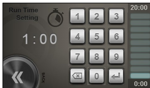
Afbeelding 22. De modus Tijd heeft een vergelijkbare functie maar de looptijd wordt bepaald in minuten en seconden.
