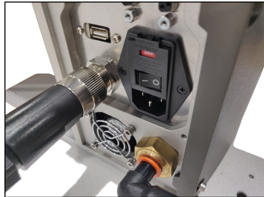
Afbeelding 7. Verbinden van luchtpomp met de achterkant van de machine.
