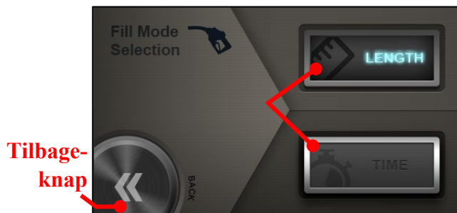
Figur 19. I menuen Valgmuligheder i påfyldningsmodus kan brugeren skifte mellem længde og kørselstid.
